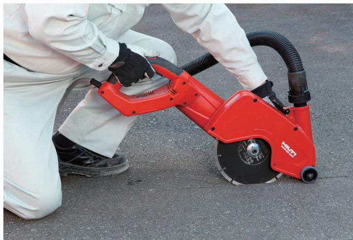
大量のノロが発生するアスファルト切断もDCH 230と専用ダイヤモンドディスクにより乾式工法での切断が可能。
