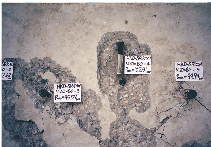
写真-20 試験項目:せん断試験 \sigma_c (N/mm 2 ): 29.3 試験体記号: HKD-SR M20×80-3~5 [試験体の状況] 複合破断
