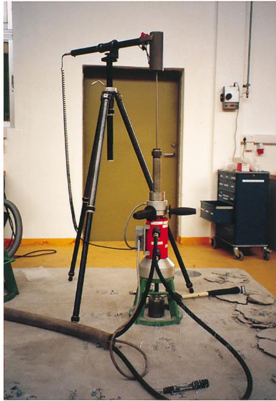
写真-1 試験項目:引張試験 〔試験実施状況〕 全景
