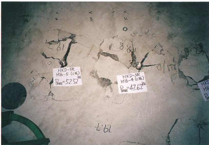
写真-10 試験項目:引張試験 \sigma_c (N/mm 2 ): 34.2 試験体記号: HKD-SR M16×65-4, 5 [試験体の状況] 複合破壊
