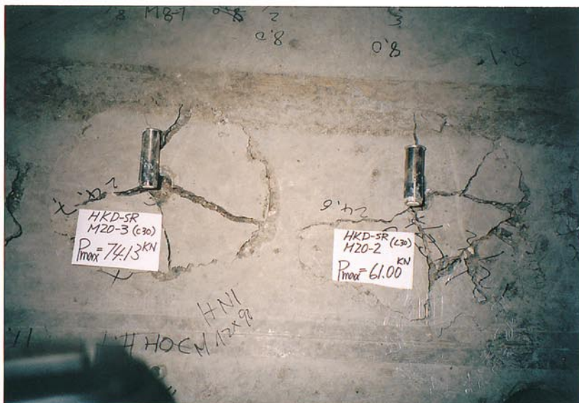
写真-11 試験項目:引張試験 \sigma_c (N/mm 2 ): 28.4 試験体記号: HKD-SR M20×80-2, 3 [試験体の状況] 複合破壊
