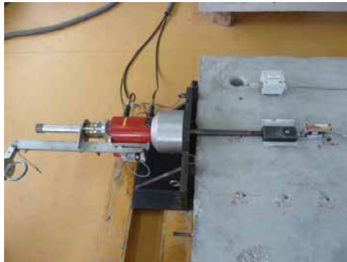
写真-2 試験方法（試験項目：せん断）
