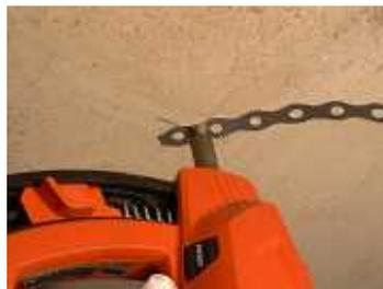
5.本体を打鋏面に強く押し当て密着させ、トリガーを引く
