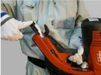
1.ガス収納室にガス缶を挿入(黒いクリップ部分がカチッとハマるまで押し込む)
