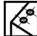
埋込み深さに対し、狭いヘリあき、アンカーピッチに最適
