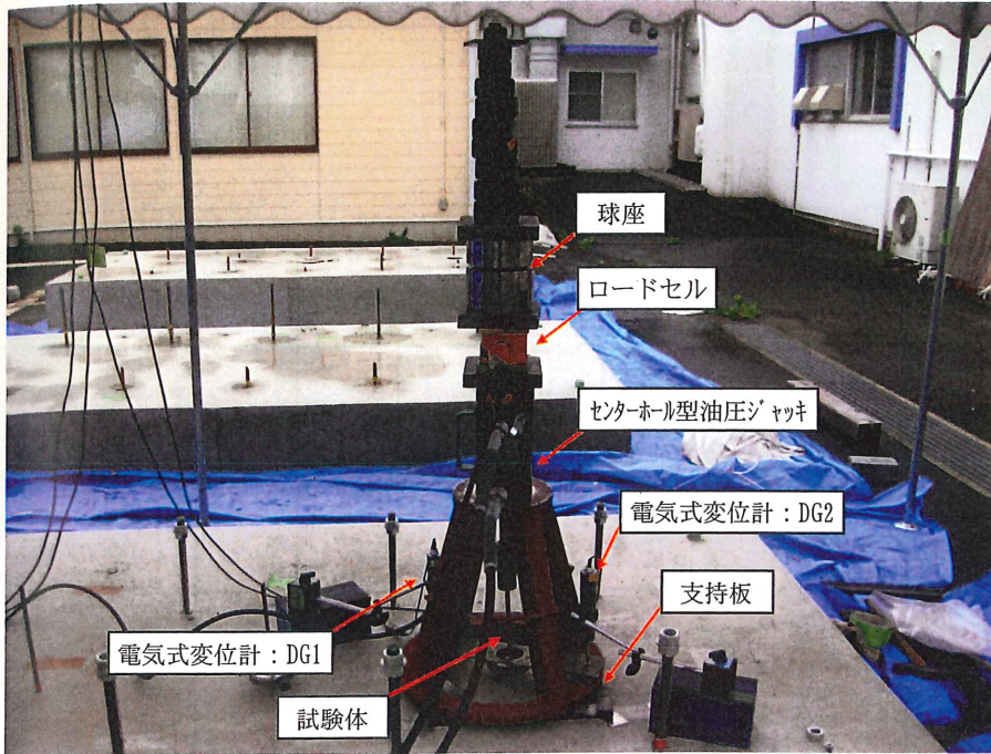
写真-1 試験実施状況 (試験項目：引張)
